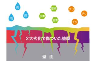
2大劣化要因で傷ついた塗膜は外気さらされることで、さらに劣化を加速させます。KFワールドセラは2大劣化を抑制することで、その他のさまざまな外的要因から建物を守ります。
