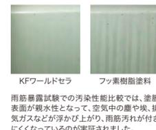
雨筋暴露試験での汚染性能比較では、塗膜表面が親水性となって、空気中の塵や埃、排気ガスなどが浮かび上がり、雨筋汚れが付きにくくなっているのが実証されました。
